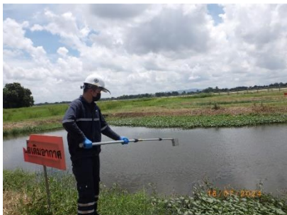
(2) น้ำทิ้งในระบบบำบัดน้ำเสีย (บ่อที่ 1 บ่อเติมอากาศ)
